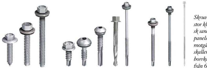
Gängpressande skruv. Två skruv med spets typ C för lättbalk <3mm och de två övriga skruven med spets typ B för stål > 3mm.
