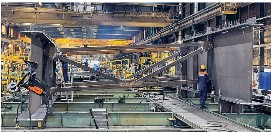
Stålproduksjon av Årbogbrua ved Nordecs fasiliteter.
