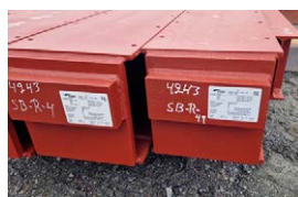
Joakim Wallström från VSAB visar några återbrukade stål balkar som väntar på transport till Göteborg. På änden av balken visar "SB-R"-märkningen att det är en återbrukad stål balk.
